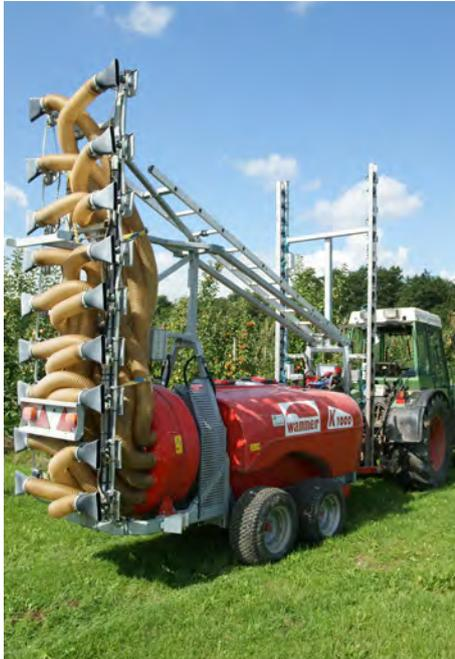
Abb. 1: Sprühgerät mit Radialgebläse.
