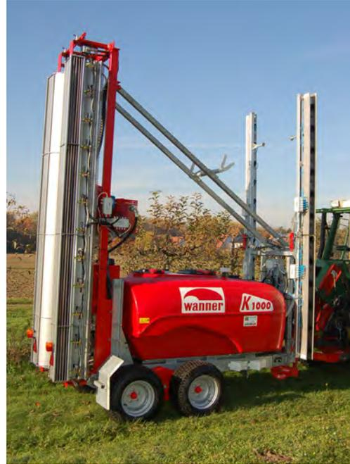
Abb. 2: Sprühgerät mit Querstromgebläse.
