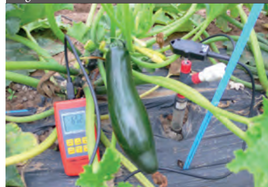
Zucchinianbau unter Folie mit Tropfbewässerung und Tensiometersteuerung im Betrieb Ewald, Trebur
