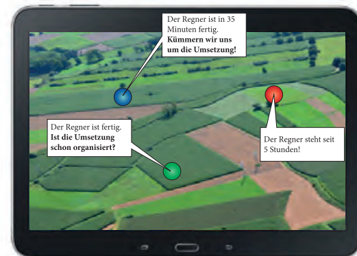
Beispiel eines Beregnungsmanagementsystems, das die Informationen per Mail oder App auf PC oder Smartphone des Betriebs in Echtzeit überträgt
