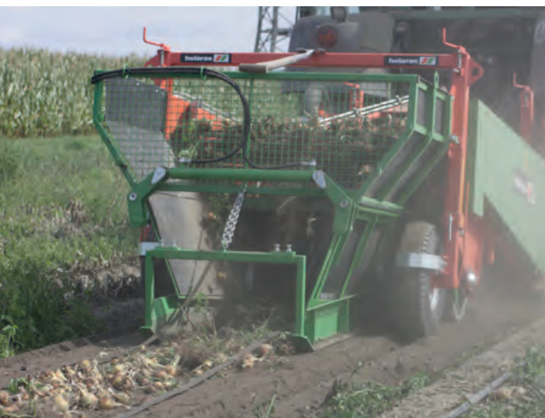
Ablage von Zwiebeln und Tropfschläuchen in einem Arbeitsgang
