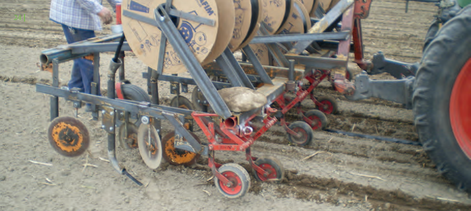
Verlegung der Tropfschläuche vor der Aussaat der Zwiebeln
