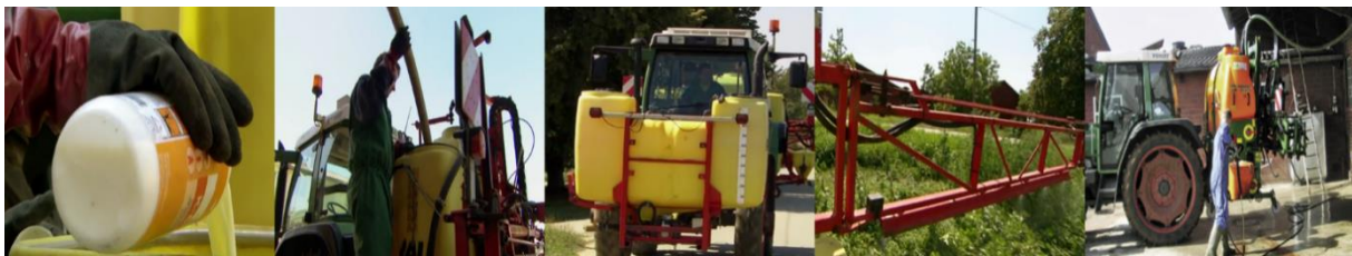
Abb. 111: Arbeitsprozesse des Arbeitsverfahrens Ausbringung von Pflanzenschutzmittel (von links nach rechts): Befüllung der Pflanzenschutzspritze mit Pflanzenschutzmittel bzw. Wasser - Transport zum Feld bzw. Hofstelle - Pflanzenschutzmittel-Applikation - Reinigen der Pflanzenschutzspritze (Quelle: Planet Schule)
