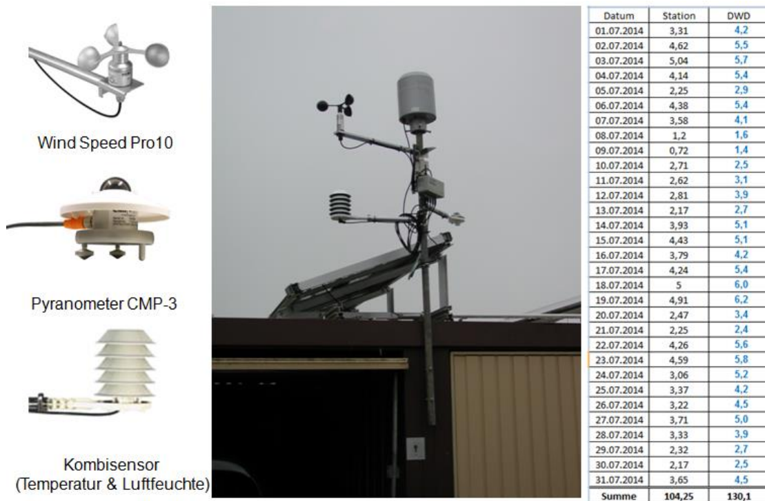
Abbildung 31: Neue Wetterstation mit Verdunstungsdaten
