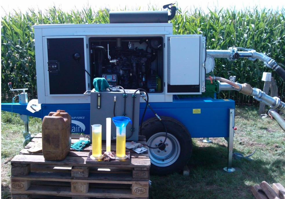
Abbildung 18: Versuchsaufbau zur Messung des Dieserverbrauchs des neuen Aggregates. Der Test erfolgte an einem baugleichen Modell im Rahmen des Aggregatetestes der Landwirtschaftskammer Niedersachsen.
