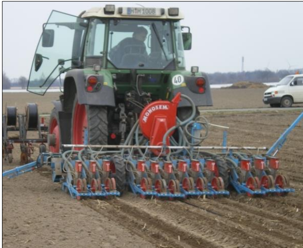
Abbildung 11: Verlegung der Tropfschläuche und Aussaat der Zwiebeln kombiniert in einem Arbeitsgang.
