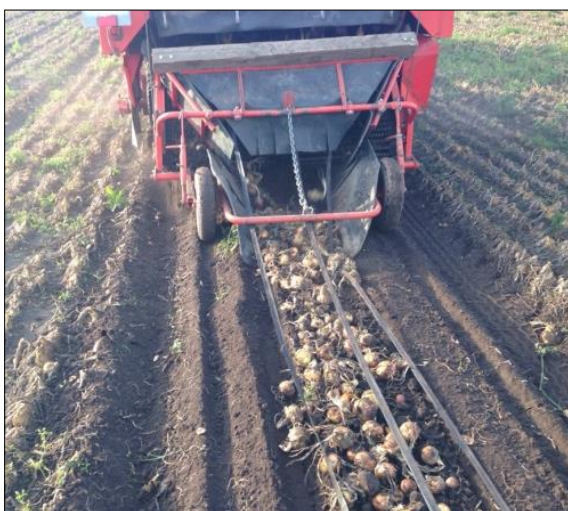
Abbildung 12: Bei der Ernte der Zwiebeln laufen die Tropfschläuche mit dem Erntegut über den Siebkettengerät und werden im Schwad abgelegt.
