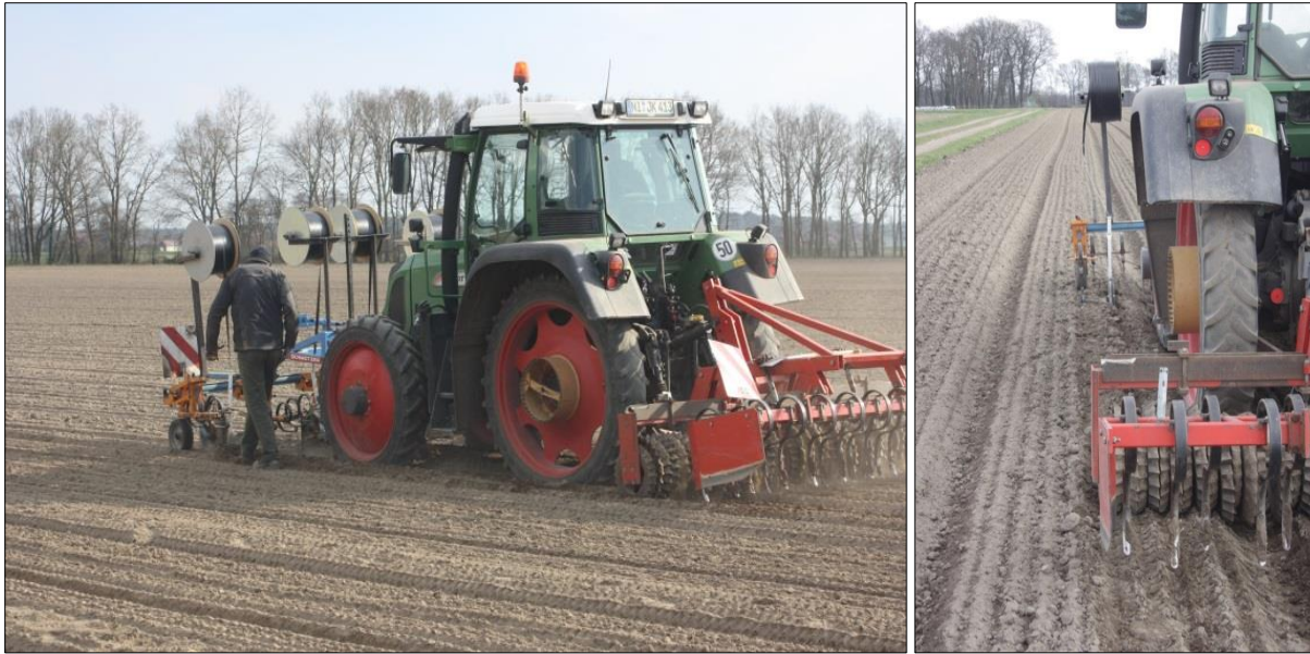
Abbildung 7: Saatbettbereitung zu Zwiebeln: Tropfschlauchverlegung in der Fronthydraulik, Einebnung und Rückverfestigung der Beete in der Heckhydraulik
