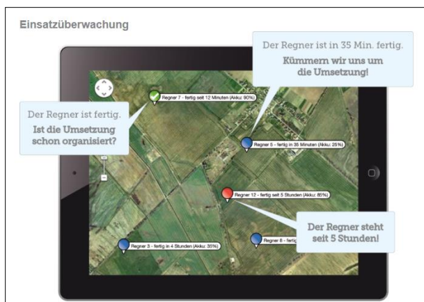
Abbildung 15: Steuerungs- und Überwachungssystem „raindancer“ (IT-Direkt Business Technologies GmbH, Berlin)
