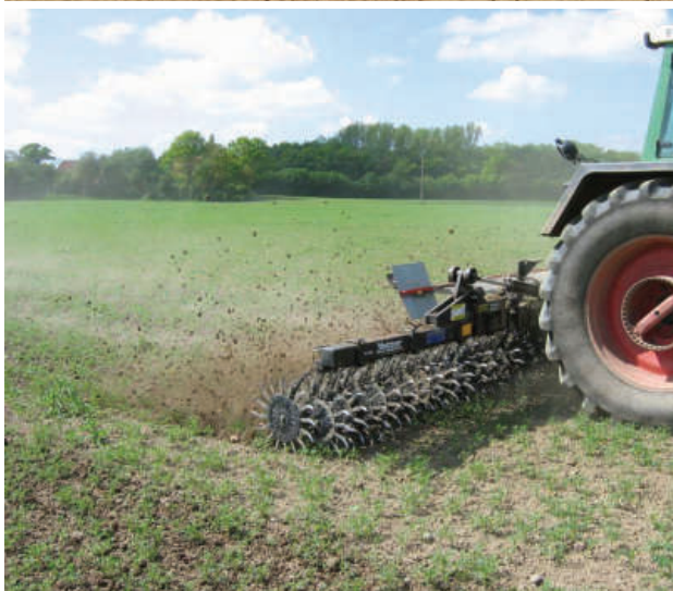
Oben: Erster Striegelarbeitsgang und Einsatz einer Gänsefußscharhacke in Lupinenbeständen Unten: Rotary Hoe-Striegel zur Unkrautregulierung und zum Krustenbrechen (im Projekt nicht verwendet)
