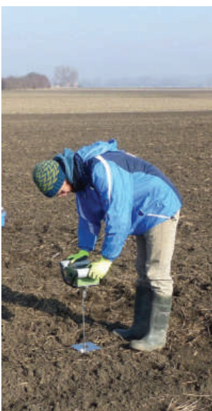
Messung des Eindringwiderstands mit einem Penetrologger (Bodensonde) vor der Lupinensaat und drei Böden mit dichtlagerndem Sand im Unterboden
