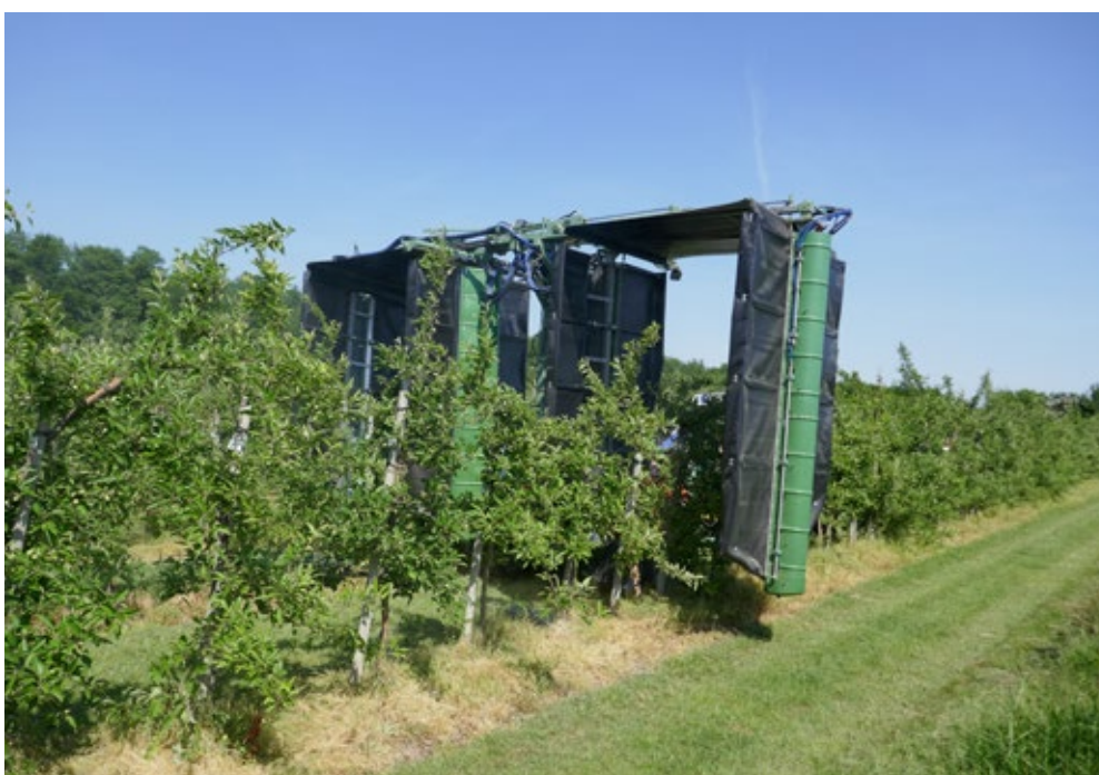
Abbildung 24: Beispiel für moderne Pflanzenschutztechnik aus dem Bereich Apfelanbau: Tunnelspritzgeräte können in Raumkulturen, wie hier in einer Apfelanlage im Alten Land, die Abdrift und die ausgebrachte Pflanzenschutzmittelmengen reduzieren.
