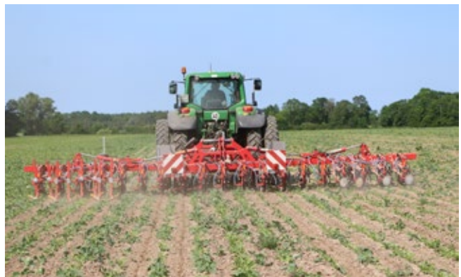
Abbildung 5: Ein Demonstrationsbetrieb erprobt die Kombination von Hacke und Bandspritze zur Unkrautregulierung. Die Anwendung von Herbiziden beschränkt sich dabei auf die Pflanzenreihen. Zwischen den Reihen wird das Unkraut mechanisch entfernt.
