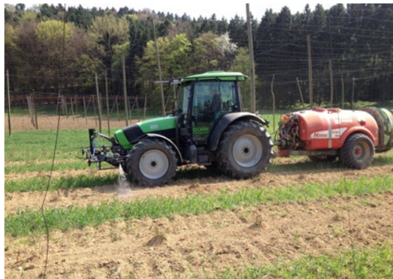
Abbildung 17 und 18: Schadbild des falschen Mehltaus an Hopfenblüten (links): Die Pilzkrankung erfordert die protektive Anwendung von Fungiziden. Die erste Bekämpfungsmaßnahme findet als Stockbehandlung statt (rechts). Sensorgesteuerte Technik ermöglicht dabei die gezielte Behandlung der Pflanzen und spart Pflanzenschutzmittel ein.
